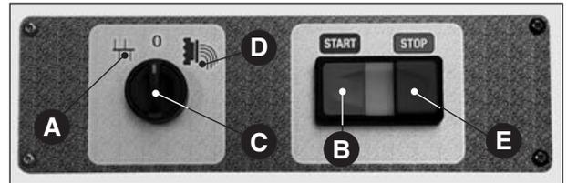
Abb. 4 – Bedientafel TR 70
